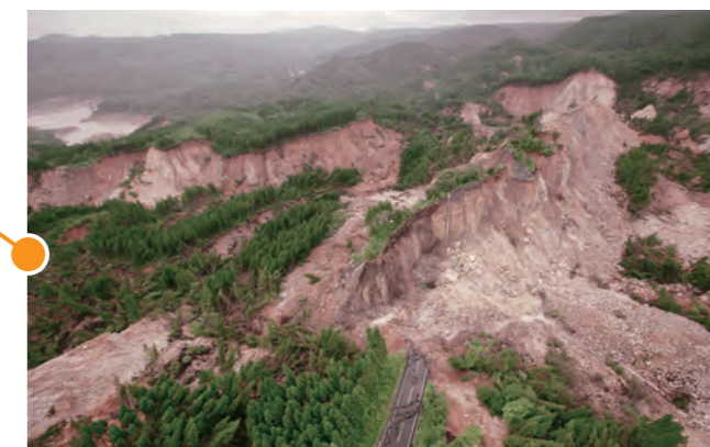
地すべりの移動量は最大で約300mに達し、市道荒砥沢線が寸断されました
