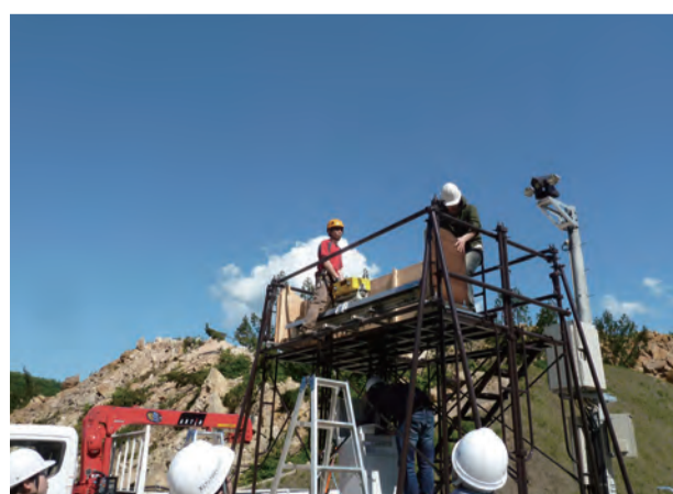
ビデオカメラとGB-SARで、同じものを別のアプローチで観測。
